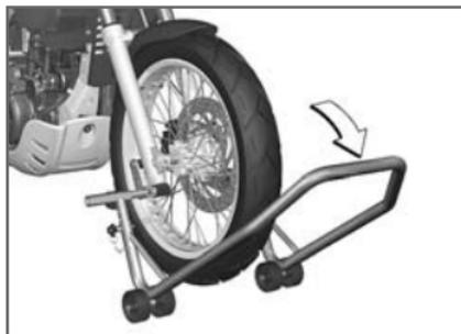
**!** Se a moto for levantada em demasia à frente, o descanso auxiliar levanta do chão e a moto pode tombar para o lado. Ao levantar a moto, prestar atenção para que o descanso auxiliar permaneça no chão. Eventualmente, adaptar a altura do apoio da roda dianteira ou do descanso auxiliar. ◀
