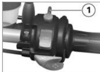
1 Interruptor de paragem de emergência
