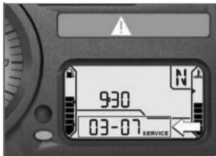
Se o tempo restante até à próxima manutenção SAV for inferior a um mês, a data para a manutenção SAV é indicada durante breves instantes a seguir ao Pre-Ride Check. O mês e o ano são apresentados em separado, com dois dígitos, separados por um traço; neste exemplo, a indicação significa "Março de 2007".
