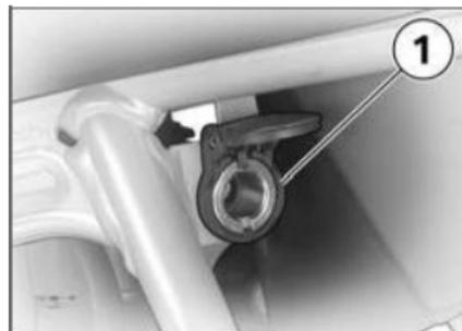
Em caso de tensão insuficiente da bateria e excedimento da capacidade de carga máxima, a tomada 1 e a tomada disponível como extra opcional (SZ) são automaticamente desligadas.
