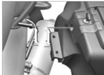
Se uma mala abanar ou se for difícil colocá-la, deverá ser adaptada à distância entre o encaixe superior e inferior.
