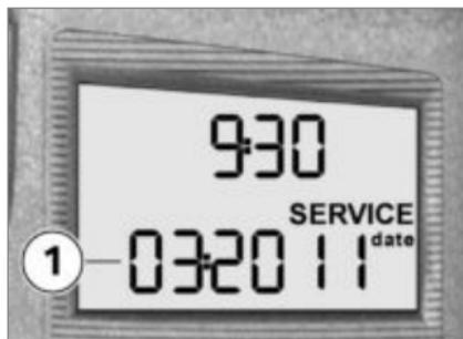
Se o tempo restante até à próxima manutenção SAV for inferior a um mês, a data para a manutenção SAV **1** é indicada durante breves instantes a seguir ao Pre-Ride Check. O mês e o ano são separados por dois pontos, sendo apresentados com dois e quatro dígitos respetivamente; neste exemplo, a indicação significa "Março de 2011".
