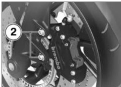
**⚠** Em estado desmontado, as pastilhas de travão podem ser apertadas até ao ponto em que não seja possível colocá-las sobre o disco de travão durante a montagem.
