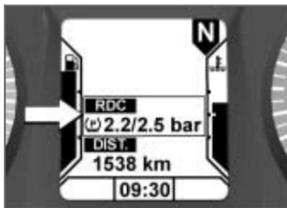
As pressões dos pneus são indicadas com a inscrição RDC. O valor à esquerda representa a pressão da roda dianteira, o valor à direita indica a pressão da roda traseira. Imediatamente após ligar a ignição é indicado ---, visto que a transmissão dos valores de pressão dos pneus só tem início a uma velocidade superior a 30 km/h.
