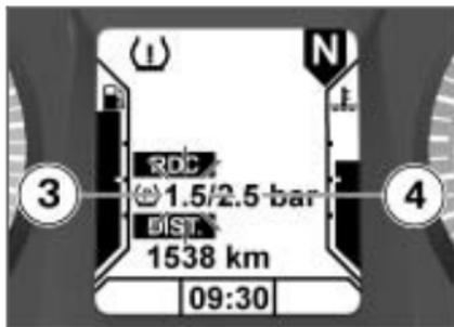
A pressão crítica dos pneus da roda dianteira **3** ou da roda traseira **4** pisca.
