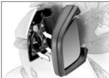
**!** Se os encaixes de borracha ou as cavilhas de retenção do retrovisor forem untadas, os retrovisores podem soltar-se com facilidade da sua ancoragem. Não untar o encaixe de borracha e a cavilha de retenção. ◀
