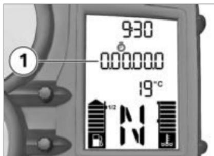
Em alternativa ao conta-quilómetros, pode aparecer o cronómetro **1**. A representação faz-se por meio de pontos, separada em horas, minutos, segundos e décimas de segundo.
