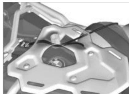
**!** Se o capacete for fixo no lado esquerdo do veículo, poderão ocorrer danificações devido ao silenciador traseiro quente.
