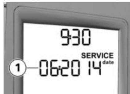
Se o tempo restante até à próxima manutenção SAV for inferior a um mês, a data para a manutenção SAV **1** é indicada durante breves instantes a seguir ao Pre-Ride Check. O mês e o ano são separados por dois pontos,
