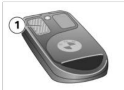
Para ativar a função de alarme depois de a ignição ter sido desligada há mais de um minuto, tem de ser acionada a tecla **1** durante mais de um segundo. Após aprox. uma hora no estado desativado, o DWA desliga-se, para conservação da bateria. Para a ativação da função de alarme após este período de tempo, a ignição tem de ser ligada e novamente desligada.
