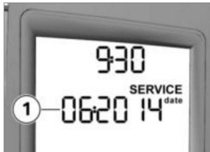
Se o tempo restante até à próxima manutenção SAV for inferior a um mês, a data para a manutenção SAV **1** é indicada durante breves instantes a seguir ao Pre-Ride Check. O mês e o ano são separados por dois pontos, sendo apresentados com dois e quatro dígitos respetivamente;
