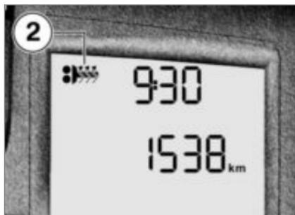
Os punhos do guiador podem ser aquecidos em dois estágios. O segundo estágio **2** serve para aquecer rapidamente os punhos; em seguida, deve comutar-se novamente para o primeiro estágio.
