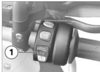
1 Interruptor de emergência
