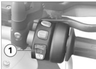
1 Interruptor de emergência
