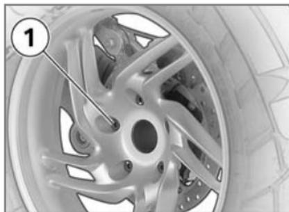
**!** Os comprimentos dos pernos da roda de raios cruzados (equipamento extra) e da roda de alumínio fundido são diferentes. A misturar ou troca dos pernos de roda dá origem a uma fixação deficiente da roda traseira,
