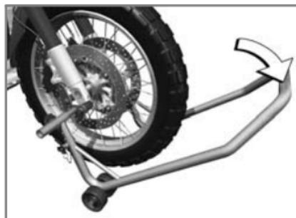
**!** Com a moto sobre o descanso central: se a moto for levantada em demasia à frente, o descanso central levanta do chão e a moto pode tombar para o lado. Ao levantar a moto, prestar atenção para que o descanso central permaneça no chão. ◀
