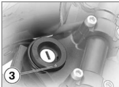
**!** Se a moto se encontrar sobre o descanso lateral, depende do piso se o guiador vira para a esquerda ou para a direita. Contudo, sobre um piso plano, a moto fica mais estável com o guiador virado para a esquerda do que com o guiador virado para a direita. Sobre um piso plano, virar o guiador sempre para a esquerda para bloquear o trancamento da direcção.◀
