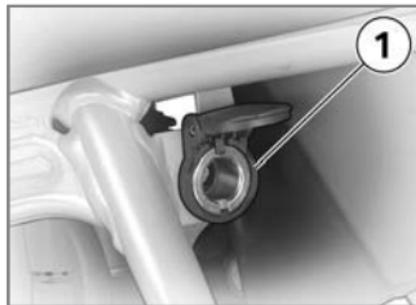
Em caso de tensão insuficiente da bateria e excedimento da capacidade de carga máxima, a tomada **1** e a tomada disponível como equipamento extra (SA) são automaticamente desligadas.
