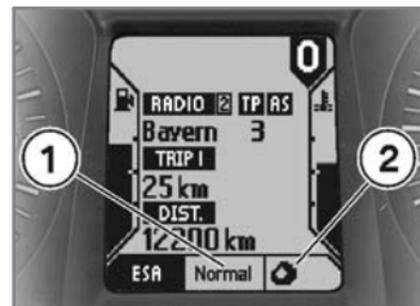
Com auxílio do ajuste electrónico da suspensão ESA poderá adaptar confortavelmente o seu veículo a diversas condições de marcha. Três tensões prévias da mola podem ser combinadas com três ajustes de amortecimento, de modo a adaptar o veículo adequadamente à carga e ao piso. O ajuste de amortecimento é indicado no display multifunções, na zona **1**,
