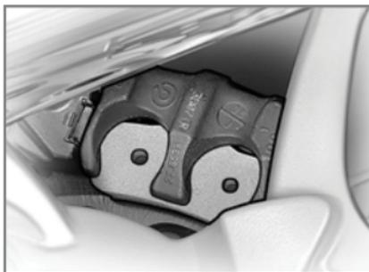
O disco de travão não deve ser visível através do orifício da pastilha do travão interna.
