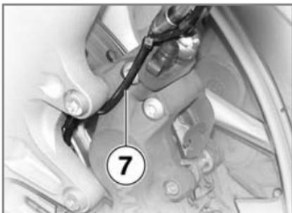
**!** O cabo do sensor ABS pode ser roçado caso toque no disco de travão. Prestar atenção à correcta colocação do cabo do sensor ABS. ◀
