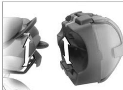
Se uma mala abanar ou se for difícil colocá-la, deverá ser adaptada à distância entre o encaixe superior e inferior. Para o efeito, pode modificar-se a altura do suporte inferior na mala.
