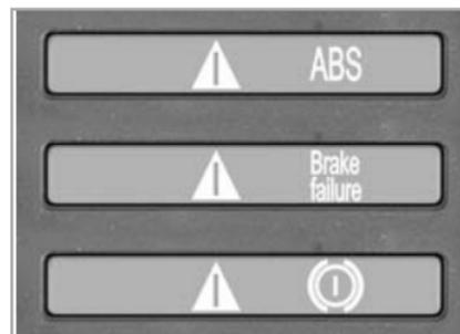
A operacionalidade do BMW Integral ABS é verificada através do autodiagnóstico e do teste de arranque (►► 62). O autodiagnóstico é efectuado automaticamente depois de se ligar a ignição.
