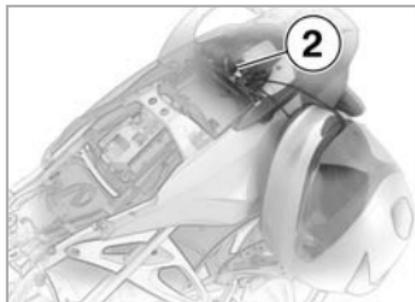
Se estiverem montadas malas ou a correia de capacete for demasiado curta, pode utilizar-se um cabo de aço para fixar o capacete de moto ao respectivo suporte **2**.
