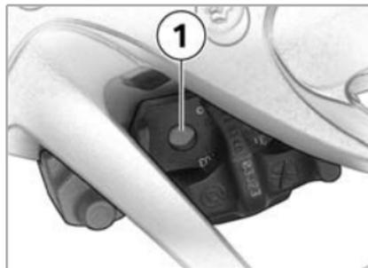
O disco de travão não deve ser visível através do orifício 1 da pastilha do travão interna.
