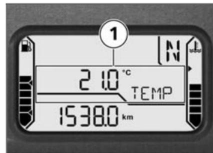
Com o veículo parado, o calor produzido pelo motor pode falsear a medição da temperatura ambiente 1. Se a influência do calor produzido pelo motor se tornar excessiva, no display é indicado temporariamente --.
