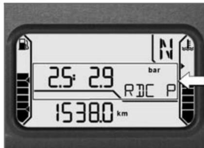
As pressões dos pneus são indicadas com a inscrição RDC P. O valor à esquerda indica a pressão da roda dianteira, o valor di-
