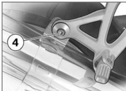
**!** Uma distância insuficiente entre a roda traseira e o silenciador pode originar um sobreaquecimento da roda traseira. A distância entre a roda traseira e o silenciador deve ser de, pelo menos, 10 mm. ◀
