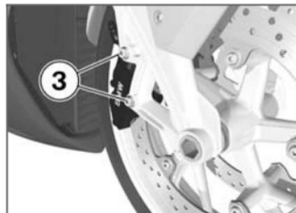
**⚠** Em estado desmontado, as pastilhas de travão podem ser apertadas até ao ponto em que não seja possível colocá-las sobre a pastilha de travão durante a montagem. Não accionar a alavanca do travão de mão com as pinças do travão desmontadas.◀
