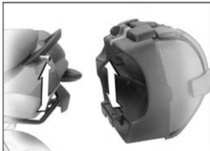
Se uma mala abanar ou se for difícil colocá-la, deverá ser adaptada à distância entre o encaixe superior e inferior. Para o efei-
