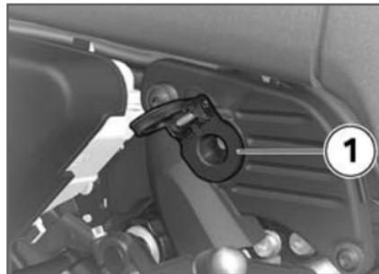
Se a tensão da bateria for insuficiente e a capacidade máxima de carga da tomada **1** for excedida, esta é automaticamente desligada.
