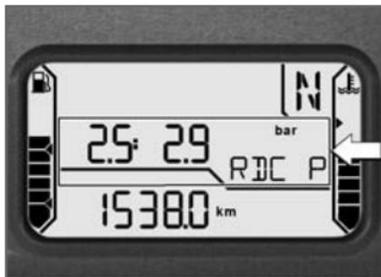
As pressões dos pneus são indicadas com o texto RDC P. O valor à esquerda indica a pressão da roda dianteira, o valor direito indica a pressão da roda traseira.
