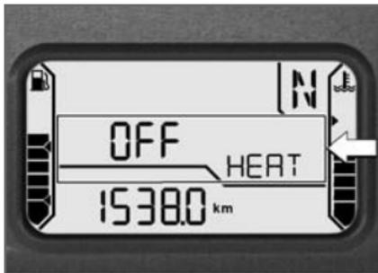
Os punhos do guiador podem ser aquecidos em dois escalões. O segundo estágio serve para aquecer rapidamente os punhos; em seguida, deve comutar-se
