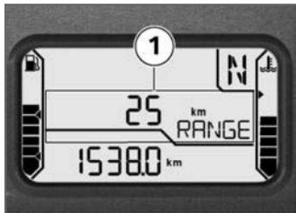
A descrição de funcionamento da autonomia restante (51) também é válida para a autonomia **1**. No entanto, também se pode chamar a autonomia antes de se atingir a reserva de combustível. Para o cálculo da autonomia é utilizado um consumo médio específico, que nem sempre coincide com o valor lido na indicação. Se o veículo se encontrar sobre o descanso lateral, a sua posição inclinada não permite determinar correctamente a quantidade de combustível. Por esta razão, o
