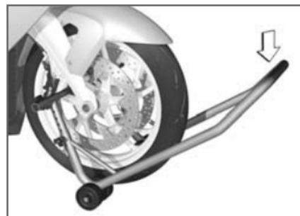
**!** Com a moto sobre o descanso central: se a moto for levantada em demasia à frente, o descanso central levanta do chão e a moto pode tombar para o lado.
