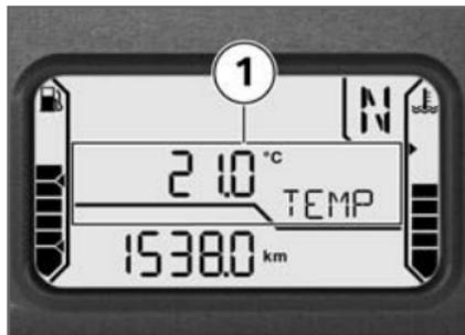
Com o veículo parado, o calor produzido pelo motor pode falsar a medição da temperatura ambiente **1**. Se a influência do
