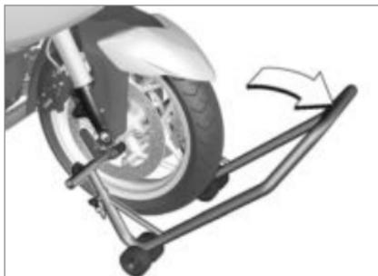
**!** Com a moto sobre o descanso central: se a moto for levantada em demasia à frente, o descanso central levanta do chão e a moto pode tombar para o lado.
