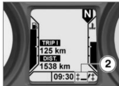
O assento do condutor pode ser aquecido em dois escalões. O segundo nível destina-se ao aquecimento rápido do assento,
