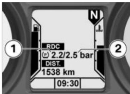
As pressões dos pneus indicadas referem-se a uma temperatura de pneu de 20 °C. O valor à esquerda **1** indica a pressão da roda dianteira, o valor direito **2** indica a pressão da roda traseira. Quando se liga a ignição, é imediatamente indicado ---, uma vez que a transmissão dos valores de pressão dos pneus só tem início depois de ser excedida pela primeira vez a velocidade de 30 km/h.<
