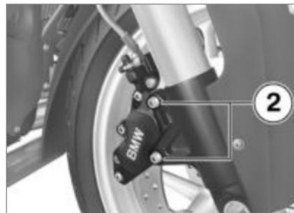
**!** Em estado desmontado, as pastilhas de travão podem ser apertadas até ao ponto em que não seja possível colocá-las sobre a pastilha de travão durante a montagem. Não accionar a manete do travão de mão com as pinças do travão desmontadas.◀
