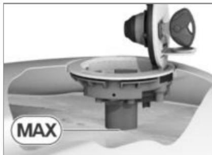
**!** O combustível expande-se sob a acção do calor. Se o depósito do combustível estiver demasiado cheio, pode
