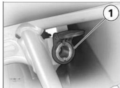
Em caso de tensão insuficiente da bateria e excedimento da capacidade de carga máxima, a tomada 1 e a tomada disponível como extra opcional (SZ) são automaticamente desligadas.
