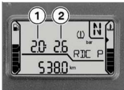
Na área de indicação da hora ou do computador de bordo, é indicada a pressão de ar da roda dianteira **1** e a pressão de ar da roda traseira **2** com a indicação RDC. A pressão de ar crítica pisca
