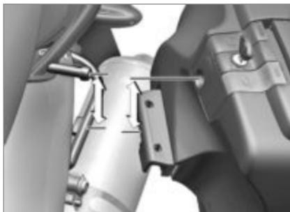
Se uma mala abanar ou se for difícil colocá-la, deverá ser adaptada à distância entre o encaixe superior e inferior.
