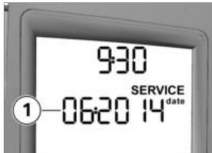
Se o tempo restante até à próxima manutenção SAV for inferior a um mês, a data para a manutenção SAV **1** é indicada durante breves instantes a seguir ao Pre-Ride-Check. O mês e o ano são separados por dois pontos, sendo apresentados com dois ou com quatro dígitos. Neste exemplo, a indicação significa "Junho de 2014".
