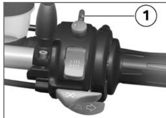
1 Interruptor de desactivação de emergência
